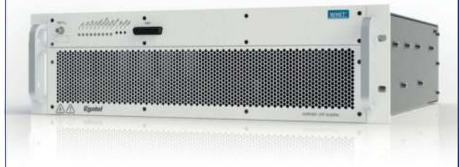
Los amplificadores se encuentran autoprottegidos al disponer de circuitos que controlan el nivel de entrada, potencia de salida y otros parámetros críticos como la temperatura del amplificador y la potencia reflejada. Estos parámetros, el valor de las corrientes de consumo de los transistores así como las alarmas generadas se envían tanto al excitador como a la Unidad de Control (opc), donde se pueden consultar a través del display, facilitando las tareas de supervisión y mantenimiento.
